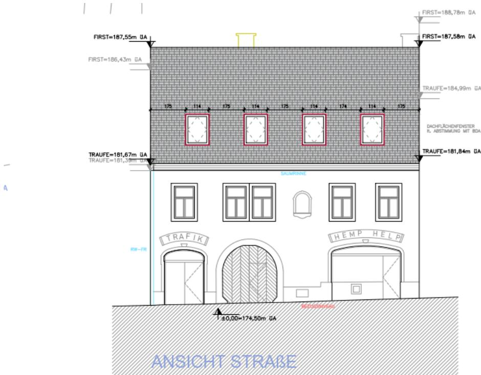
Abbildung 23: ÄP 19, Auszug aus dem Vorabzug zum geplanten Dachgeschoßausbau, Straßenansicht, Quelle: BERGER LENZ Architekten ZT GmbH, Projektnummer 0408-1, Plannummer 201-1 vom 01.02.2024)
